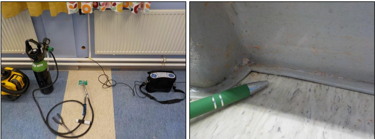
Kuva 2.26. Yleiskuva merkkikaasututkimuksesta MA3. Merkkikaasu virtasi nopeasti kokeen aloittamisen jälkeen muovisen jalkalistan alta huonetilaan. Listan alla on silminnähtävä rako.
