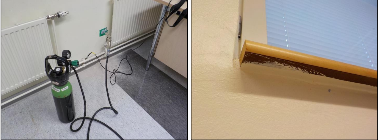
Kuva 2.25. Vasemmalla on yleiskuva merkkikaasututkimuksen suorituksesta. Oikealla on esimerkki ikkunalaudan tiivistyksestä elastisella tiivistysmassalla. Tästä ikkunaliitoksesta ei havaittu vuotoja merkkikaasulla.
